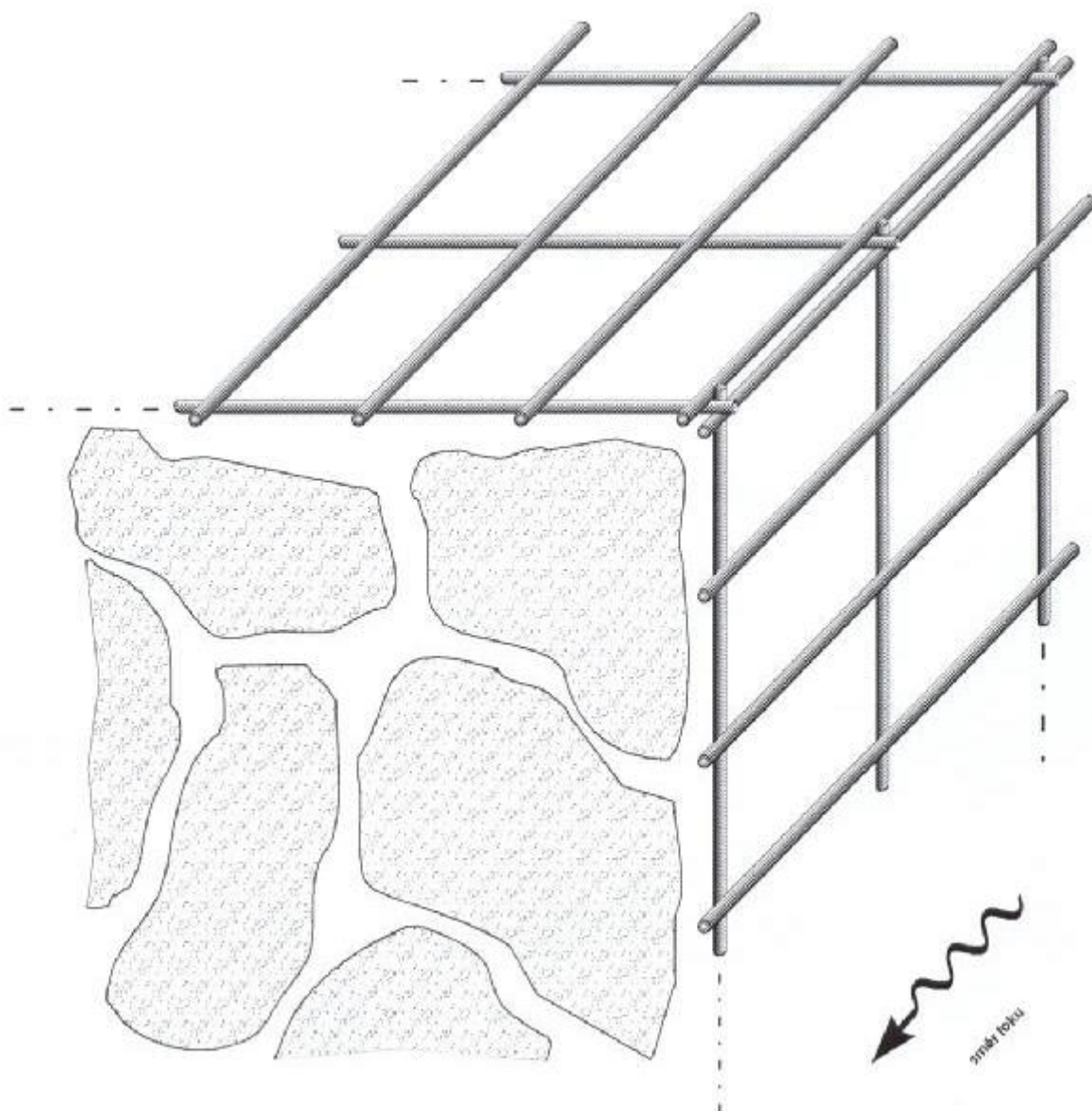
obr. 19 - schéma orientace vnější sítě při styku s vodním tokem
