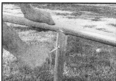
5. K hlavnímu rámu přišroubujte nejdříve zkompletované nohy
