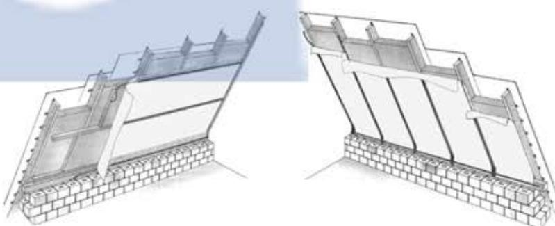
Parotěsné fólie se mohou instalovat jak vodorovně tak svisle - dle potřeby.
