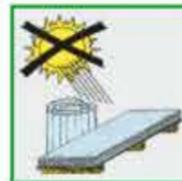
**Skladování:** Desky skladujte na rovné ploše nebo na dřevěné paletě. Desky položené na sobě nikdy neskladujte na přímém slunci nebo v teplotě nad 60°C. Desky zvyšují koncentraci slunečních paprsků do určitých míst, čímž může dojít k deformaci spodních desek. Uskladněné desky chraňte též před mechanickým poškozením, deštěm a dalšími nepříznivými vlivy. Po deskách nechoďte.
