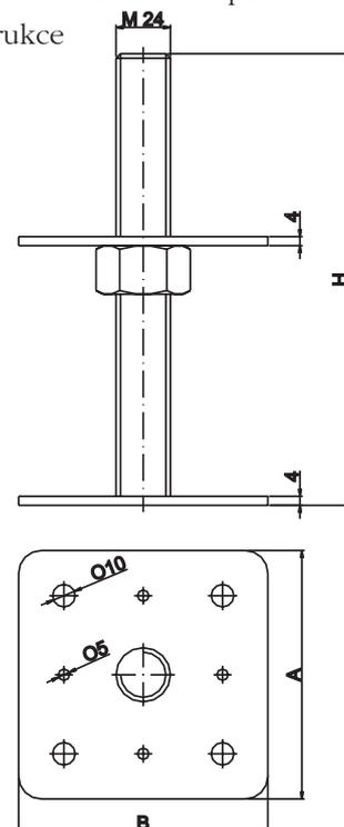
Použití kotvy: Kotvení tlačných sloupů a pilířů k vodorovné nosné konstrukci s odsazením dřevěného prvku
