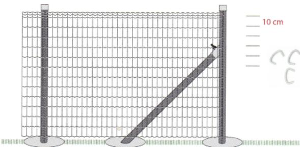
Na koncovém sloupku opět pomocí sponek a kleští přichytíte pletivo ke sloupku. U koncového sloupku dejte sponky každých 10 cm výšky pletiva. Přebytečné pletivo pak můžete odštípnout pomocí štípacích kleští.
