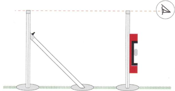
Při hutnění betonu dávejte pozor, aby byly sloupky kolmo k zemi a zároveň je usadte tak, aby byly všechny ve stejné výšce. Doporučujeme zabetonovat tak, aby ze země koukal sloupek o výšce pletiva + 3-5 cm. Beton před napínáním pletiva nechte vytuhnout alespoň 3-5 dnů.
