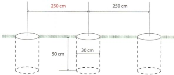
Do vyhloubených děr o průměru cca 30 cm a hloubky alespoň 50 cm (ideálně 80 cm) usadte sloupky, zasypte betonem a řádně uhněte. Rozstupy mezi sloupky by měly být 2,5 až 3 metry.
