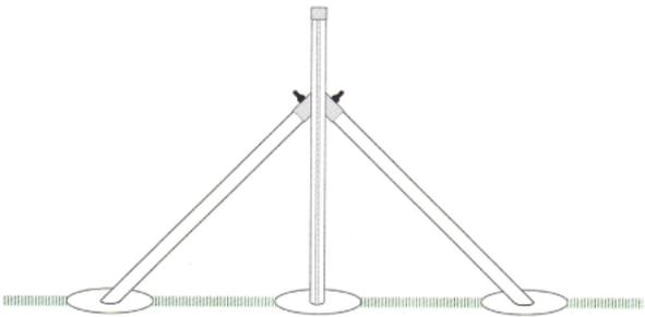
Vzpěra se dává na začátek a konec, na všechny rohové sloupky a na každý sloupek, u kterého se mění směr plotu. U průběžných sloupků je nutné dát vzpěru oboustranně každých 25 metrů.
