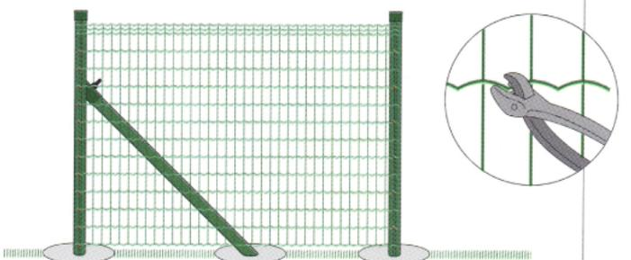
Pomocí kreovacích kleští provedte dovypnutí pletiva v plotovém poli. Prohnutím drátu snížíte vzdálenost vertikálních drátů v jedné řadě a tím dojde k natáhnutí pletiva v poli.
