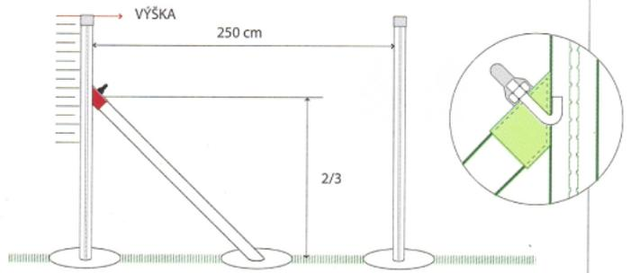
Boční vzpěry o stejné výšce jako je sloupek, se připevňují cca do 2/3 výšky sloupku. Do sloupku se předvrtá díra o průměru 8 mm, do které se následně vloží ocelová kotva ve tvaru "J". Ta se pak z vnější strany dotáhne a přiklopí čepičkou. Spojovací materiál je součástí vzpěry.
