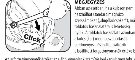
Az új forgatónymaték értékét az alábbi egyenlet kiszámításával kapjuk meg (obr. 4):  $N(A)=N \times [(A+B)/B]$
