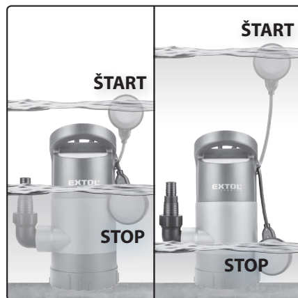
Obr. 4, ilustrácia funkcie plavákového spínača
